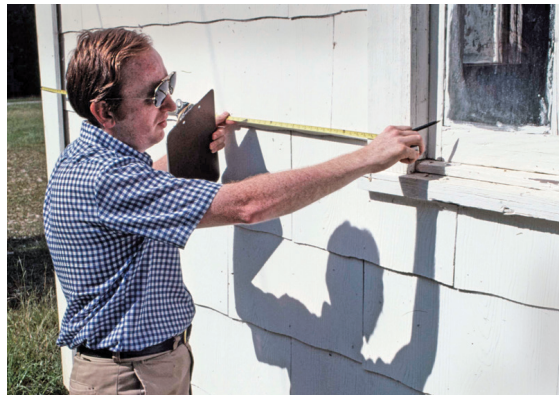
La cinta métrica de acero sigue siendo su mejor selección para medidas precisas de edificios. Otras cintas se estiran ligeramente, por lo que cuanto más largo sea el elemento que está midiendo, menos precisas serán. En esta foto, el investigador de campo Howard W. Marshall toma las medidas de un edificio. Proyecto de tradición popular de Georgia del Sur Central (South-Central Georgia Folklife Project), 1977. Foto de Carl Fleischhauer.
